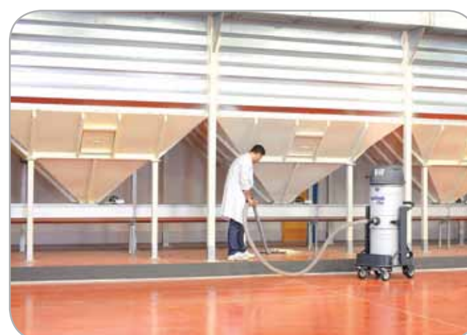
S3 avec système de déchargement par gravité Longopac®
