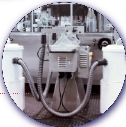
Succion ponctuelle sur un équipement de compression et succion de poussières dans l'industrie pharmaceutique.
